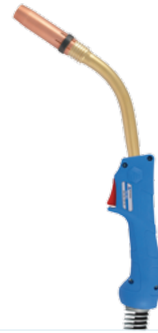
TBi 380 60% (10 min.) Mix: 360 A CO 2 : 380 A Ø 1,2-1,6
