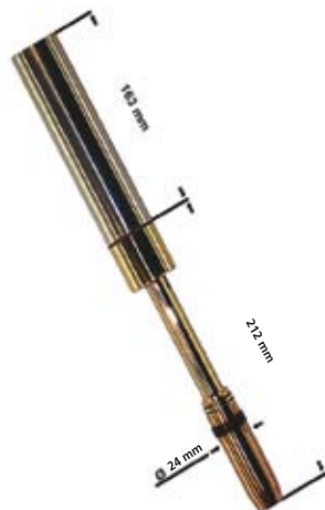
TBi AUT 511 100% (10 min.) Mix: 450 A CO 2 : 500 A Ø 1,0-1,6 mm
