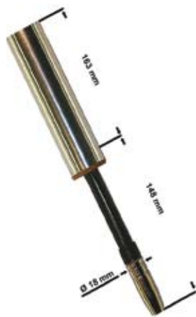
TBi AUT 150 60% (10 min.) Mix: 150 A CO 2 : 180 A Ø 0,6-1,0 mm
