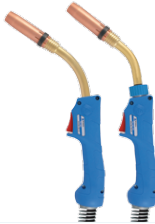
TBi 360(DR) 60% (10 min.) Mix: 335 A CO 2 : 350 A Ø 1,0-1,2 mm
